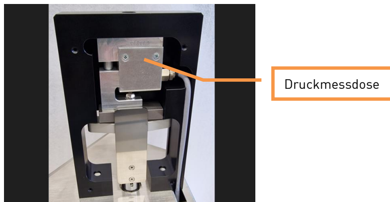
Abbildung 17: Blick auf die Druckmessdose, nachdem die untere Abdeckung entfernt wurde
