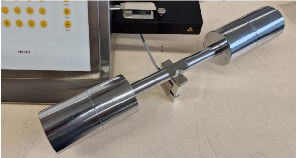
Abbildung 20: Platzierung eines 10kg Kalibrierengewicht auf der Druckmessdose
