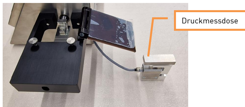
Abbildung 18: aufrechte Platzierung der Druckmessdose, bereit für Justierung und Kalibrierung
