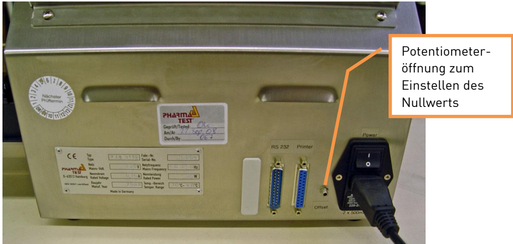
Abbildung 19: Potentiometeröffnung zum Einstellen des Nullwert
