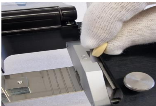
Abbildung 7: Einsetzen des Prüflings zur Höhenmessung
