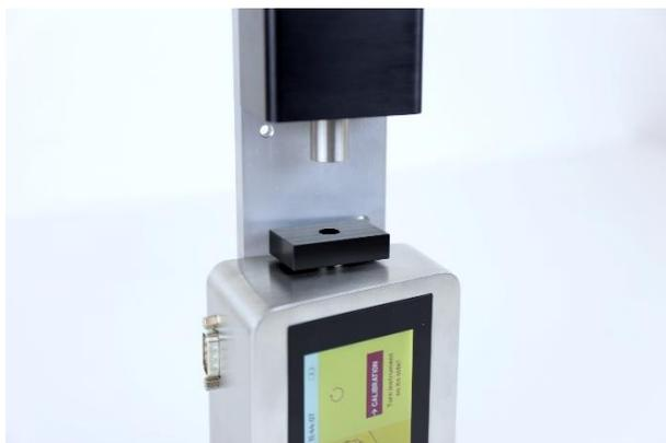
Setzen Sie die Kalibrierungsauflage auf den Kraftsensor.
