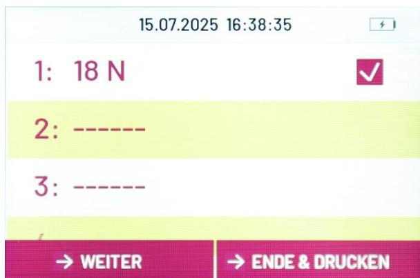
Die Anzeige wechselt dann automatisch zur Ergebnistabelle. Wischen Sie auf dem Touchscreen nach oben und unten, um in der Tabelle zu scrollen. In einem Durchgang können bis zu 100 Messungen durchgeführt werden.
