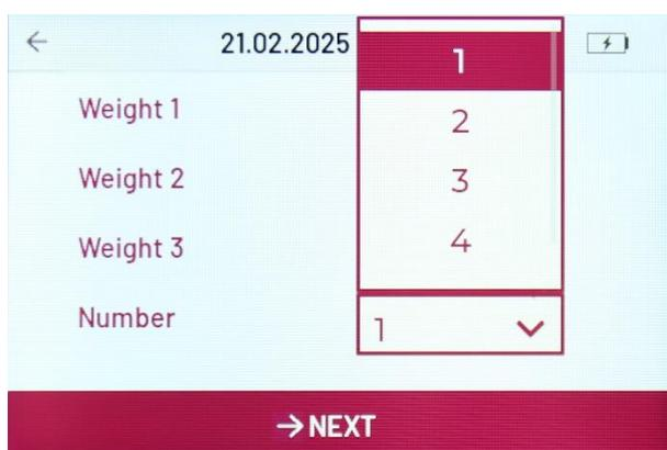
Wählen Sie anschließend aus dieser Dropdown-Liste die Anzahl der Messungen pro Referenzgewicht aus. Sie können bis zu fünf Kalibrierungsmessungen durchführen.
