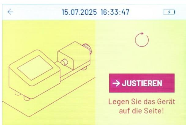
Um das Justiergewicht auf den Kraftsensor zu legen, muss das Gerät auf die Seite gedreht werden. Dazu muss zunächst das USB-Kabel vom PTB-M100 getrennt werden.
