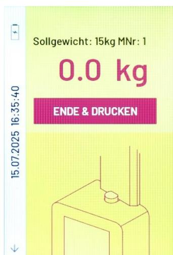
Wenn Sie die letzte Messung erreicht haben, ändert sich die Schaltfläche **OK** zu **QUIT & PRINT**. Tippen Sie auf diese Schaltfläche, um die Kalibrierung zu beenden. Wenn ein Drucker angeschlossen ist, wird der Kalibrierungsbericht automatisch ausgedruckt.
