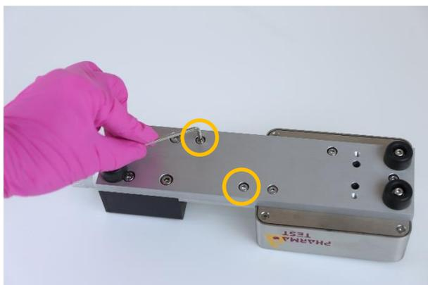
Schrauben Sie die Probenauflage mit einem Inbusschlüssel der Größe 3 von der Unterseite ab und entfernen Sie diese.
