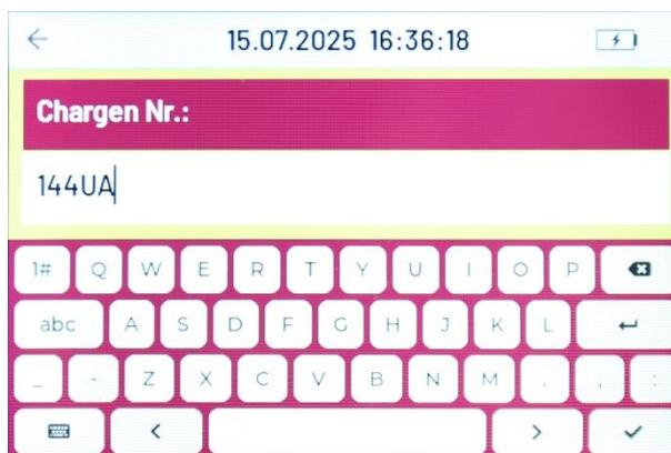
Nach dem Antippen von **MESSUNG** wird die Bildschirmtastatur angezeigt, über die Sie eine alphanumerische Chargennummer eingeben können. Für die Chargennummer können bis zu xxx Zeichen eingegeben werden.
