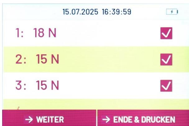
Im Falle einer fehlerhaften Messung deaktivieren Sie das Kontrollkästchen rechts neben dem fehlerhaften Ergebnis. Dadurch wird dieses Ergebnis als ungültig markiert und aus der Statistik des Ergebnisberichts ausgeschlossen.
