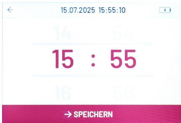
Um die Uhrzeit zu ändern, wischen Sie einfach auf dem Touchscreen nach oben oder unten, um die Stunden und Minuten zu ändern.
