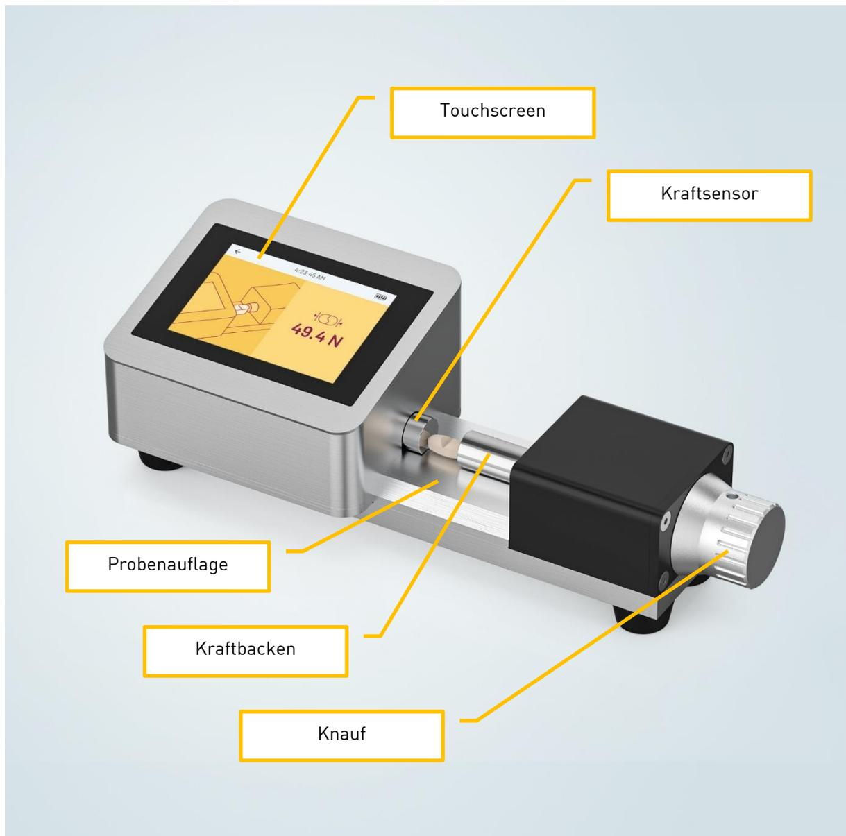
Abbildung1: PTB-M100 Hauptkomponenten
