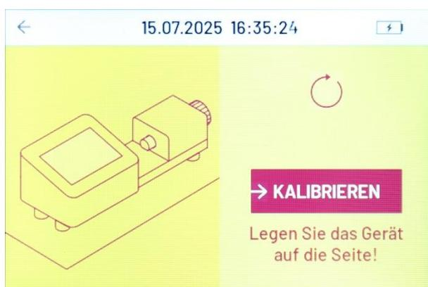
Um die Kalibriergewichte auf den Kraftsensor zu legen, muss das Gerät auf die Seite gedreht werden. Dazu muss zunächst das USB-Kabel vom PTB-M100 getrennt werden.
