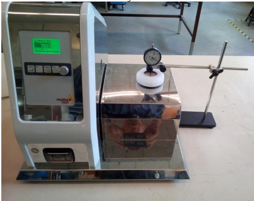
Bild 7: Aufbau des SWT-TDx00 zur Hubhöhenkalibrierung
