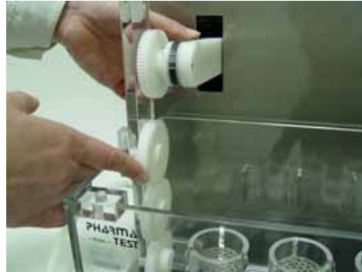
Ausrichten der Aufnahme im Bad
